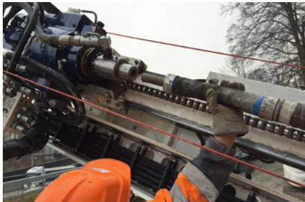
1. KÜPS® ankoppeln am Bohrhammer.
