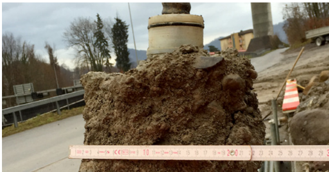
230mm nomineller Durchmesser mit 100 mm Bohrkronengrösse
