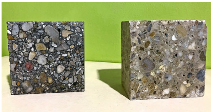
Beton mit (links) und ohne Pyrokohle: Ein Teil Pyrokohle reduziert drei Teile CO 2 des Gesamtprodukts.
