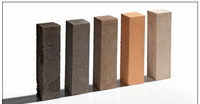
Alkalisch aktivierte Binder (Geopolymere), hergestellt am Fraunhofer IBP unter Verwendung unterschiedlicher primärer und sekundärer Rohstoffe.
