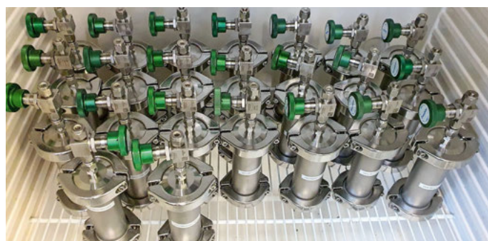
Abschnitte aus dem Sedimentkern bereit zur Porenwasseranalyse mit dem an der Eawag entwickelten, portablen Massenspektrometer GE-MIMS.
