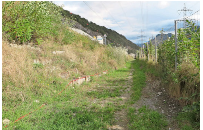
Grosslaborversuch Calanda (GR), Blickrichtung Nordost; links: eingebauten Faschinen (Aufnahme vom 05.08.2021); rechts: Entwicklung der Begrünung nach ca. drei Jahren. (Aufnahme vom 26.09.2024)
