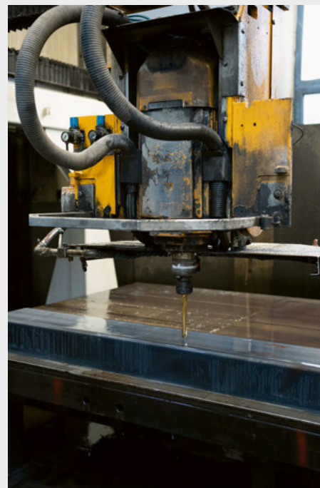
Strail kann sämtliche Bohrungen und Fräsungen zum Beispiel für Weichen oder die Schwellenbefestigung an den Kunststoffschwellen selbst vornehmen.
