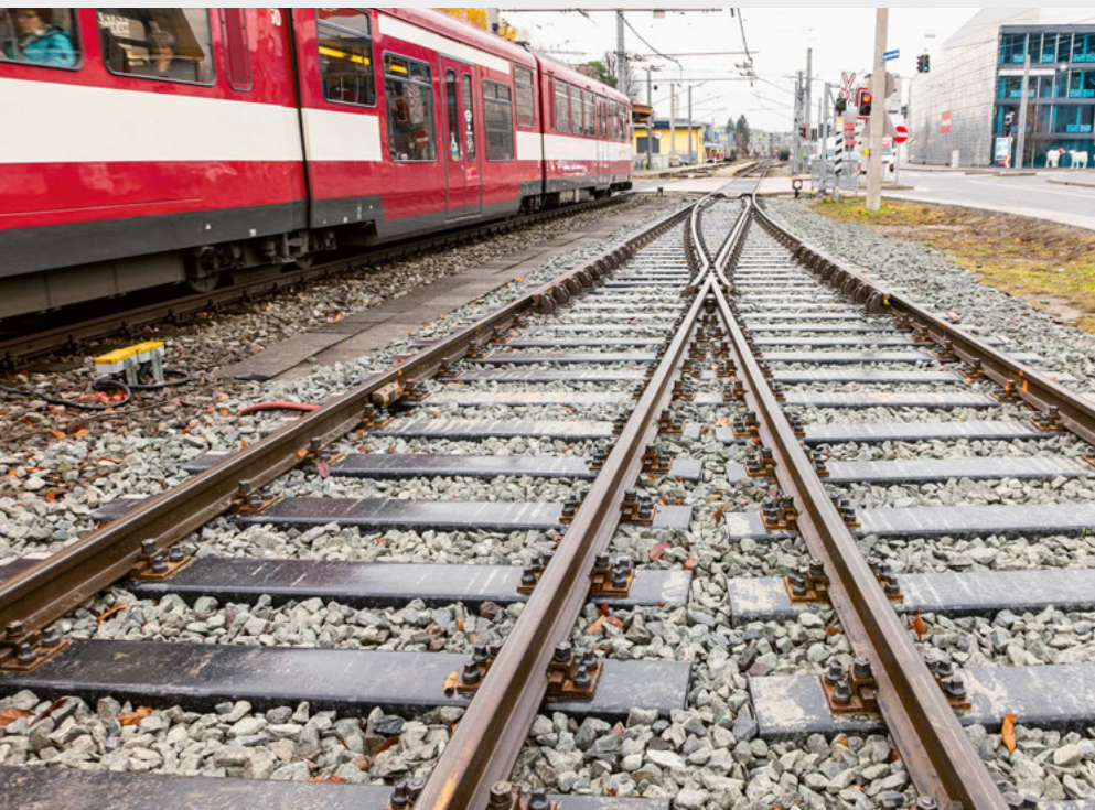
Die STRAILway Kunststoffschwelle wird immer gefragter, da sie leicht, langlebig und einfach handzuhaben ist.
