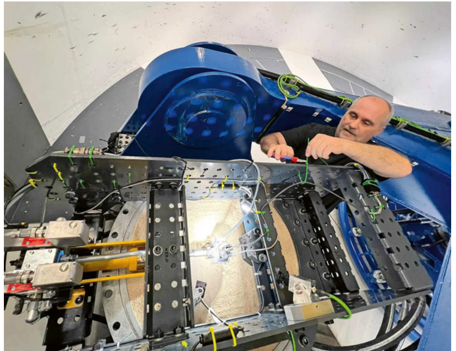
Der Mechaniker Markus Iten trifft die letzten Vorbereitungen, bevor ein Modell eines Pfahls getestet wird.
