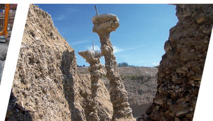
Système d'ancrage autoforant
