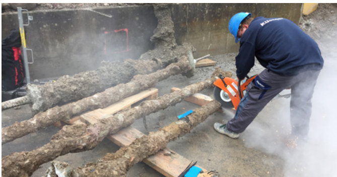
Drei geprüfte KÜPS -Anker. 6 Schnitte bei jeder Muffe.
