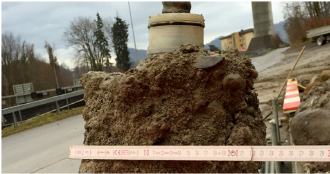
230mm nomineller Durchmesser mit 100 mm Bohrkronengrösse
