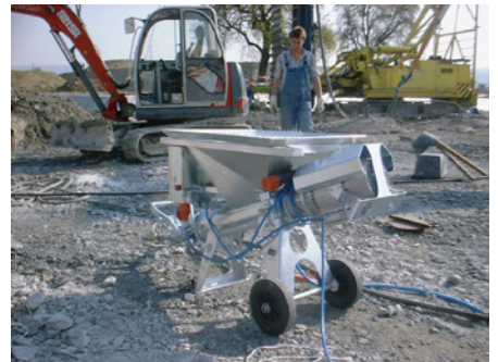
K MUNG® Injektionsanlage max. 70 bar Injektionsdruck
