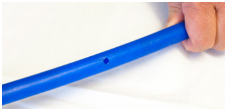
Vorgebohrtes Loch im Schlauch
