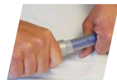
Fixieren des Ventils und Quetschhülse mittels K Quetschrohr
